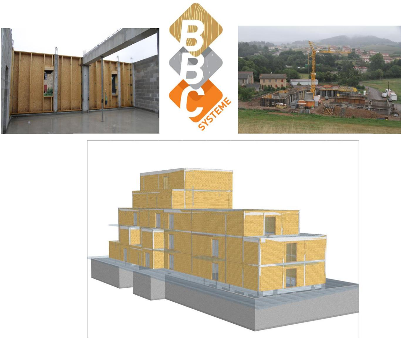
« BBC Système » est un système constructif bois-béton breveté pour les immeubles de grande hauteur jusqu'à R+8 aujourd'hui développé conjointement par les Ets FARJOT et le CENTRE TECHNIQUE BBC.
